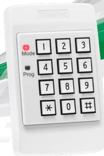
AY-D19M это считыватель бесконтактных карт с клавиатурой. Идеально подходящий для частного и коммерческого использования. AY-D19M снабжен такими расширенными функциями, как ультра-яркий светодиодный индикатор, функция обнаружения несанкционированного вскрытия, мембранная клавиатура и встроенный зуммер. AY-D19M поддерживает несколько форматов проксимити карт и клавиатуры для обеспечения высокого уровня совместимости и подключения к контроллерам.
